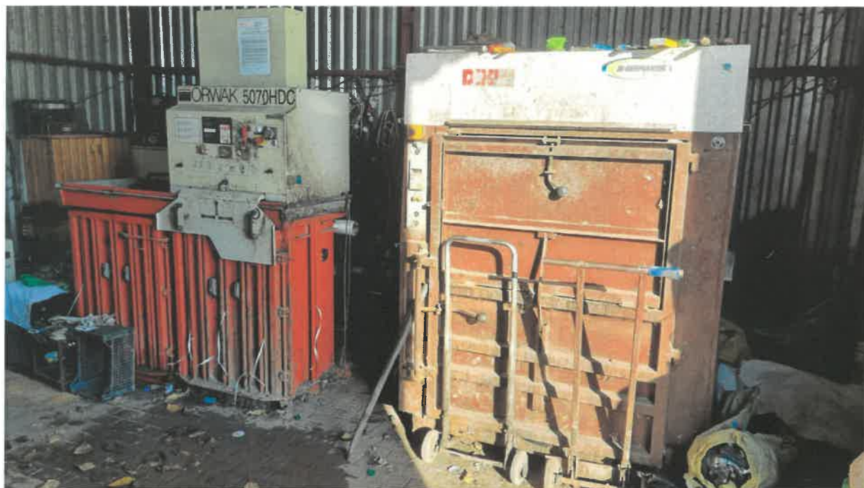
Zdjęcia nr 7-8. Zdjęcia prasy wykorzystywanej do prasowania wyselekcjonowanych odpadów.
